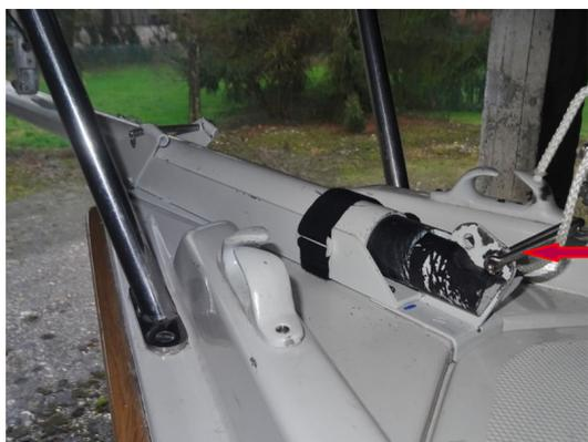
La cadène est insérée dans le logement prévu et le mousqueton du point d'amure l'empêchera de monter, mais pas de se déplacer vers l'avant, ce qui permet montage ou démontage.
