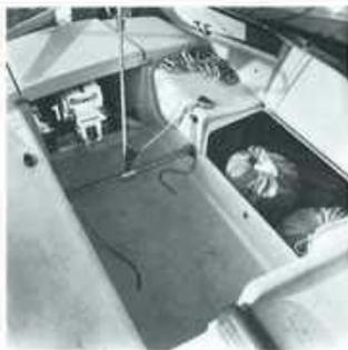
3 grands coffres d'un volume surprenant, moteur dans un puits avec tôle de fermeture.
