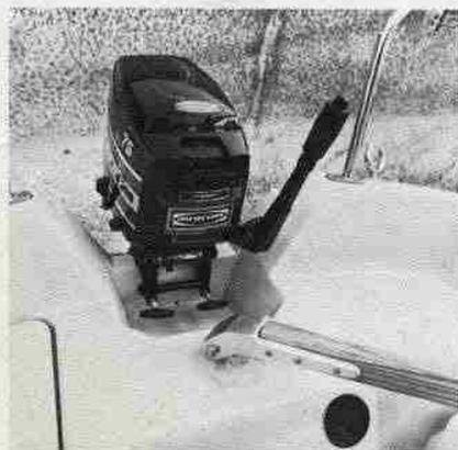
Support moteur incorporé à la coque permettant la navigation moteur à poste.
